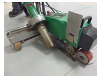
Рисунок 5.15. Применение бандажной полосы из армированной полимерной мембраны для стыковки полотен полимерной мембраны на горизонте
